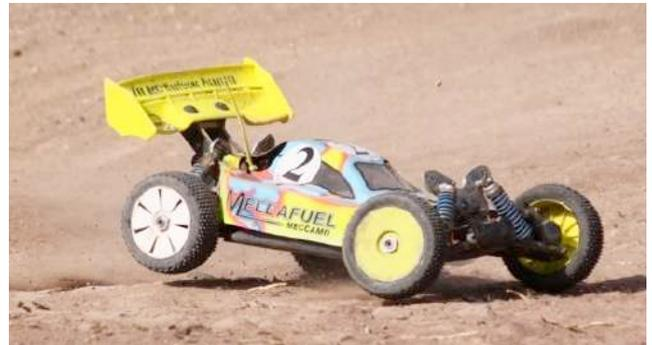
Pour ces 2 catégories il existe 2 types de propulsion soit moteur thermique de 3,5cc, soit moteur électrique de 1900kv à 2200 kv (pour la plupart des pilotes pratiquant en compétition). Les moteurs thermiques sont alimentés par une essence spécifique alors que les moteurs électriques sont alimentés par des batteries au lithium de diverses capacités.
