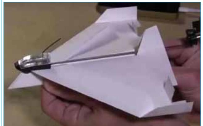
On peut voir sur cette vidéo un petit avion papier radiocommandé qui est piloté par un téléphone... Génial, ça vole vite et parfaitement avec une dérive sur le moteur pour virer et l'accélération pour la prise d'altitude !
