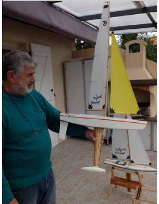
Jean-Paul Tricoire a conçu il y a maintenant 3 ans le Baby Voile, un petit voilier de 50 cm dont la coque est découpée dans un bloc de polystyrène extrudé et les voiles dans du papier de fleuriste ou de la toile de cerf volant. Ce modèle de début existe en deux versions : une libre et une radio-commandée.
