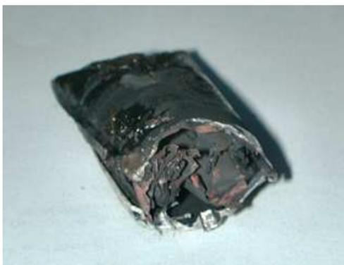
**Destruction d'un lipo** : Contrairement à une idée reçue (et répandue) ne pas utiliser d'eau salée ! (trop conducteur, donc décharge trop rapide, d'où échauffement et risque d'explosion).
